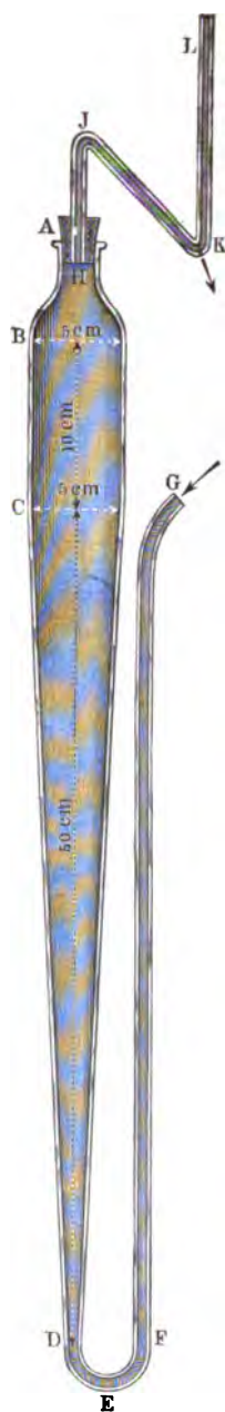
Fig. 54. — Entonnoir à lévigation de l'appareil de Schöne.
